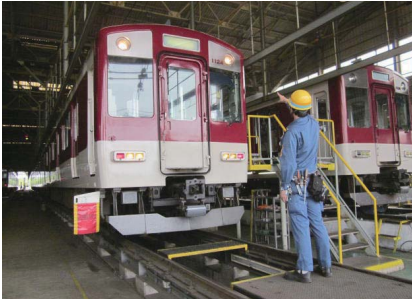
ヘッドライト、標識灯等の点灯状態の検査
