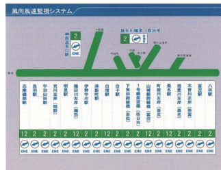
風向風速監視システム画面
