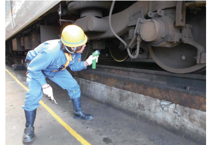
台車・ブレーキ装置の検査
