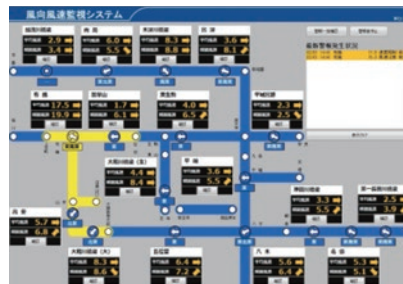
風向風速監視システム画面
