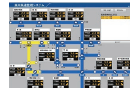
風向風速監視システム画面
