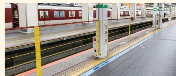
▲ドア位置が異なる等、多岐にわたる車種に対応できるロープ型の可動式ホーム柵の設置を進める
